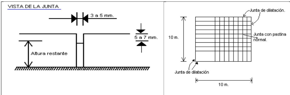
Colocado el piso, limpiar perfectamente el sector de junta de dilatación, rellenar la misma con fondo de junta flexible (telgopor de baja densidad) hasta 5 ó 7 mm. por debajo del nivel superior y luego aplicar la junta propiamente dicha.- (Ver copia anterior).
